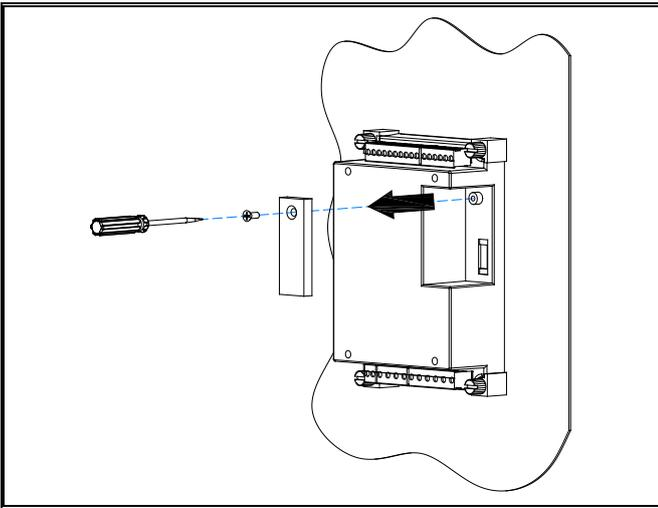
步驟2：將KCU-XX模組插入ATS-245的電路板，並將螺絲鎖緊。
